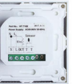
N и OUT – подключение термоплёнки;
